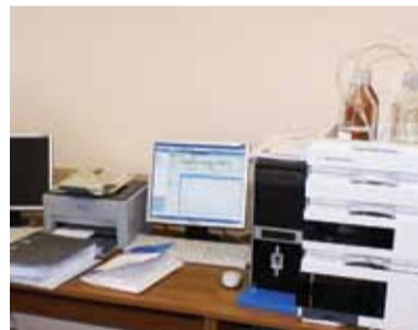
Жидкостные хроматографы для определения содержания пестицидов, афлатоксинов, витаминов, бензапиренов.
