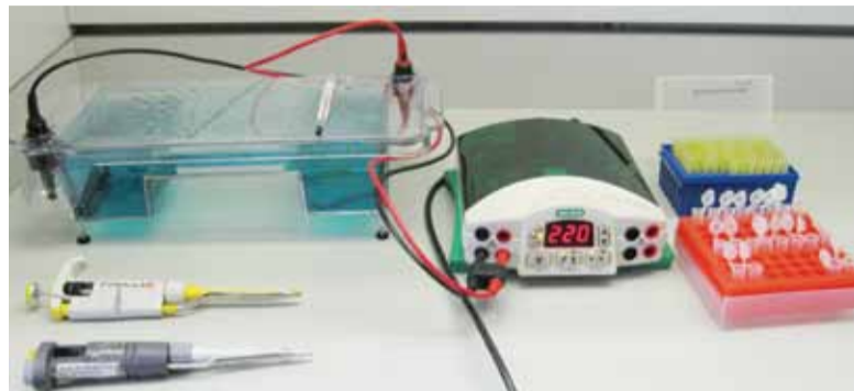
Установка электрофореза для определения сортовой чистоты семян.
